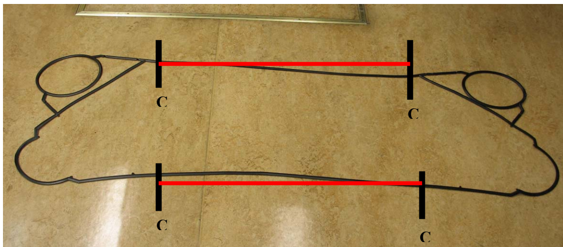
Figur 7 Den undersökta packning A15B och dess mätintervaller, sida A och B; inte skalenligt.
