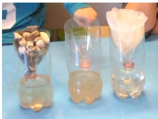
Bild 1. Vattenrening genom plastflaskor med stenar, sand och kaffefilter. På bilden har sanden i mittenflaskan avlägsnats.
