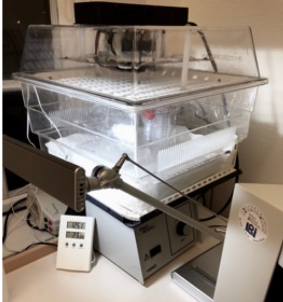
Figur 4. Inkubator med kontinuerlig vit ljus, ventilation och temperatur inställd på 23°C. (Bild: Andersson 2018).
