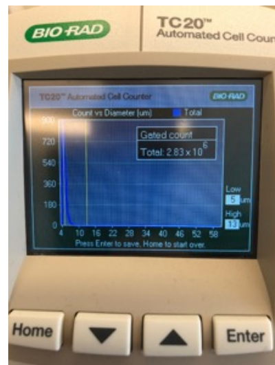
Figur 1. Gated count. TC20 cellräknaren kan räkna celler per en bestämd celldiameter. (Bild: Andersson 2018)
